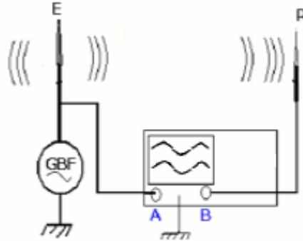
يبعث الهوائي الباعث موجة كهرومغناطيسية لها نفس تردد الإشارة الكهربائية التي أحدثت على مستواها. وتنتشر هذه الموجة في الهوائي المستقبل إشارة كهربائية لها نفس التردد.
